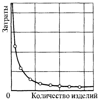
Рис 1.13.1. График сокращения затрат на технологическое оборудование и оснастку, приходящихся на одно изделие, с увеличением выпуска изделий
